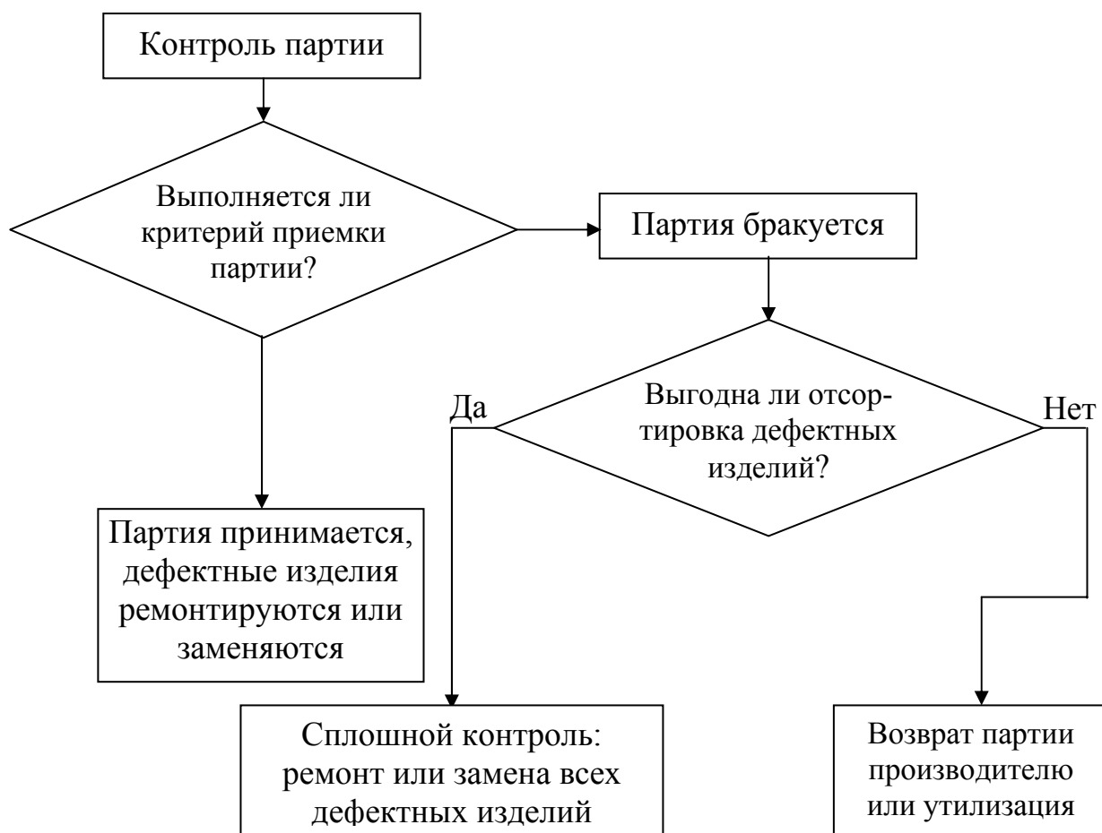
Рисунок 3.1 – Возможные действия с изделиями контролируемой партии и дефектными изделиями
