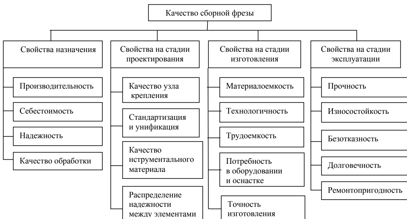
Рис. 1. Структура комплексных свойств, составляющих качество сборной фрезы
