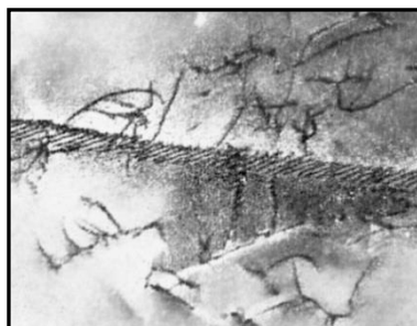
Рис. 3. Возникновение дислокационных построений в стали аустенитного класса 03X18H11 ( \times 20000 )
