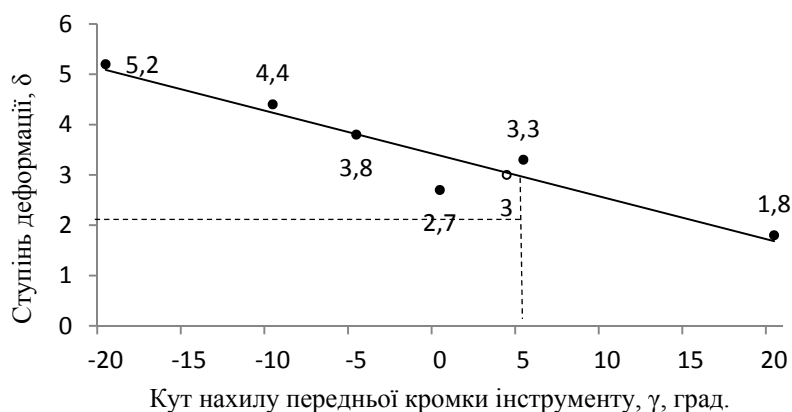
Рис. 3. Графік залежності ступеня деформації від кута нахилу передньої кромки інструменту (виділене значення, отримане дослідженням, наведеним у даній роботі)
