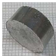
Рис. 4. Спресовані брикети з металевих волокон сплаву АД1
