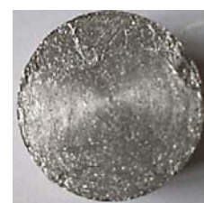
Рис. 4. Спресовані брикети з металевих волокон сплаву АД1
