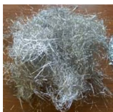
Рис. 3. Загальний вигляд волокон зі сплаву АД1
