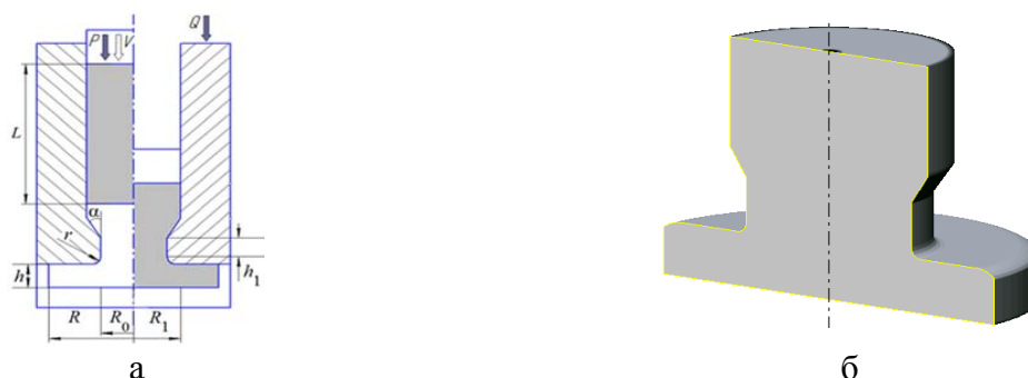
Рис. 1. Схема процесса закрытого радиального выдавливания фланца с редуцированием (а) и полученный полуфабрикат (б)
