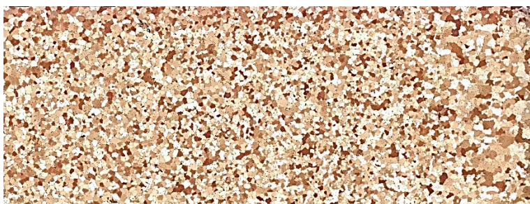
Рис. 3. Микрофотографии исходной микроструктуры сплава АД0
