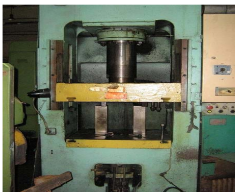
Рис. 1. Гидравлический пресс кафедры ОМД им. Акад. Чекмарёва А. П.
