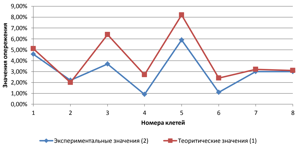
Рис. 4. Сравнительный график экспериментальных и расчетных значений опережения
