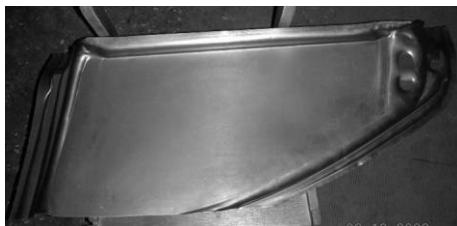
Рис. 4. Внешний вид участка отштамповки из стали IF толщиной 0,75 мм. Заметного коробления не отмечено
