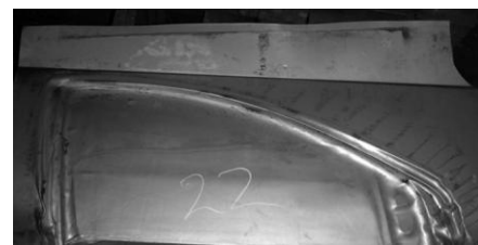
Рис. 5. Внешний вид отштамповки промежуточного типа. Для оценки степени коробления борта детали используется плоская линейка (изображена в верхней части рисунка)
