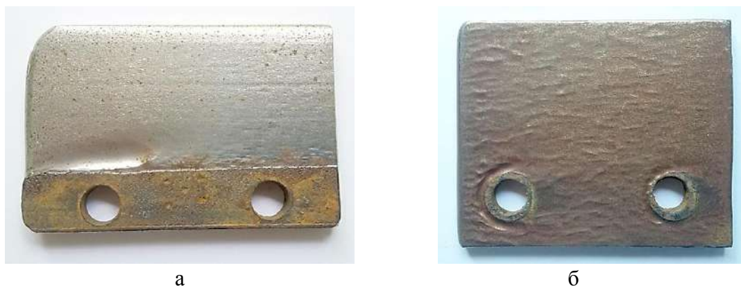
Рис. 6. Зразки після випробувань: а – еталонний зразок; б – зразок сталі 120Г3С2
