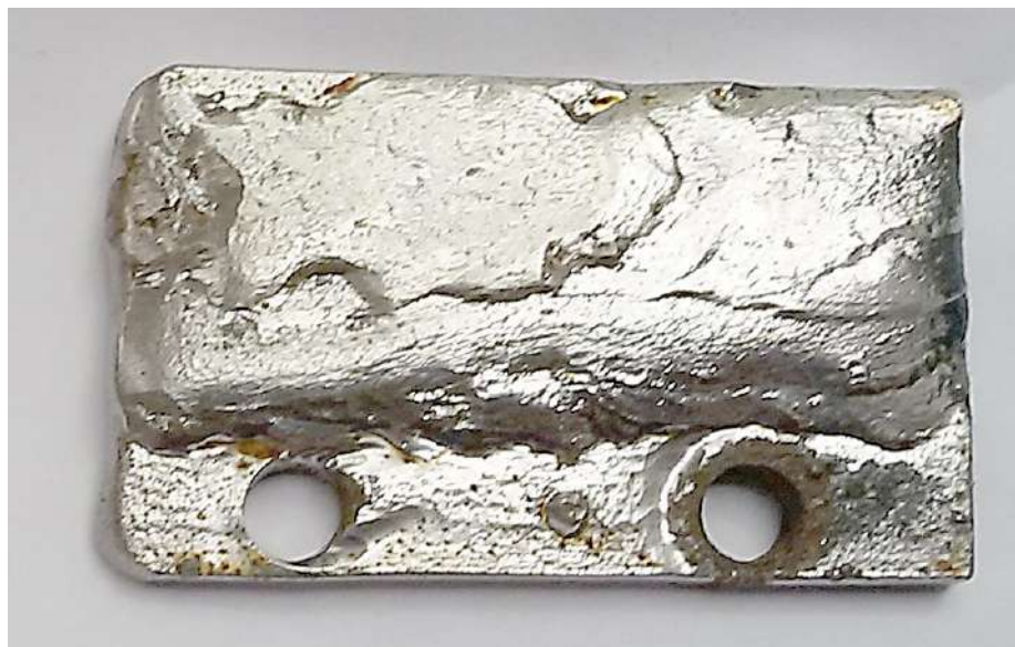
Рис. 11. Наплавлений зразок після випробувань
