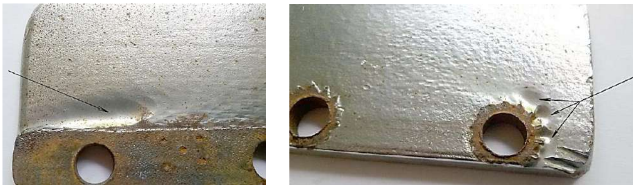
Рис. 9. Характер локального підвищеного зносу еталонного зразка
