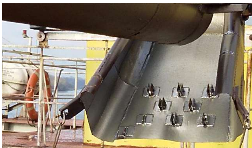
Рис. 4. Пара зразок-еталон, яку встановлено на кронштейнах 1 – еталон; 2 – зразок із досліджуваних матеріалів
