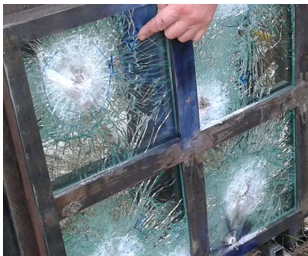
Рис. 1. Вигляд системи бронювання з блоків 300 \times 300 \times 42 мм після ураження кулею БЗ з відстані 100 м
