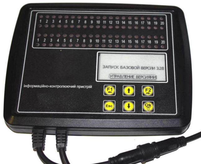
Рис. 3. Пульт системи керування віддаленими об'єктами й охорони об'єкта в екрані запиту оновлення
