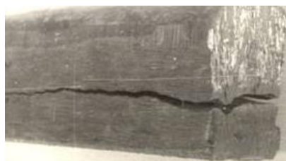
Рис. 4. Характер руйнування наплавленого зразка
