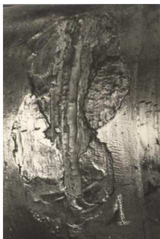
Рис. 2. Відкол металу робочого шару, наплавленого на сталь 90ХФ
