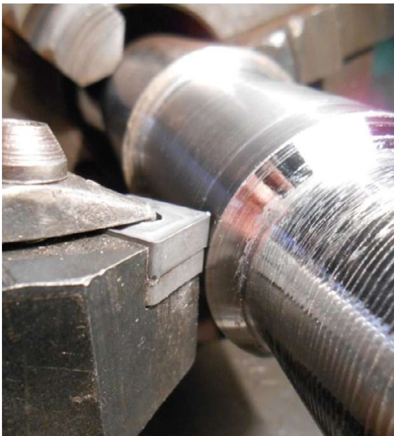
Рис. 1. Положення пластини відносно вала при визначенні опору руйнуванню і зносу при контактному навантаженні на токарних верстатах
