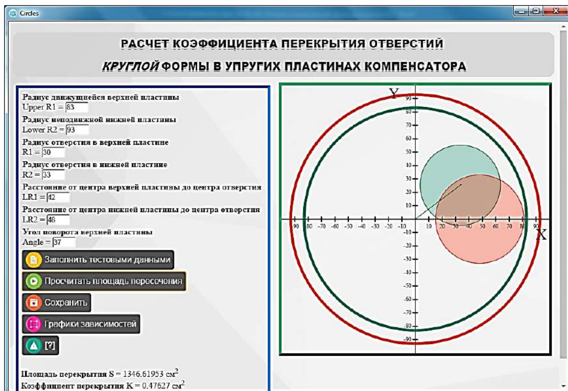
Рис. 4. Окно программного модуля «Circle Calculator» для расчета коэффициента перекрытия отверстий круглой формы в упругих пластинах компенсатора
