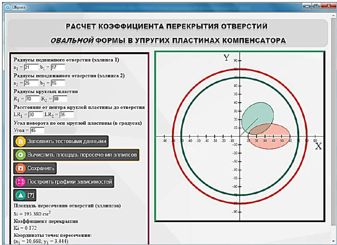
Рис. 3. Окно программного модуля «Ellipse Calculator» для расчета коэффициента перекрытия отверстий овальной формы в упругих пластинах компенсатора
