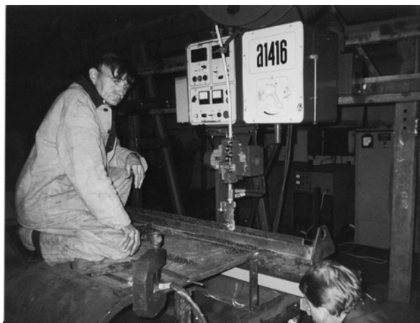
Рис. 4. Сварка медного кристаллизатора для ЭШП
