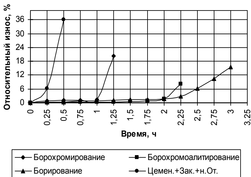
Рис. 3. Влияние продолжительности испытаний на износостойкость образца из стали Ст. 3сп
