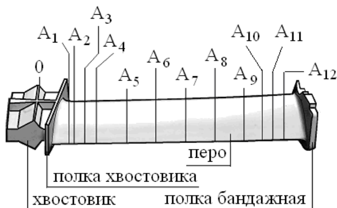
Рис. 5. Схема обмера профиля пера турбинной лопатки
