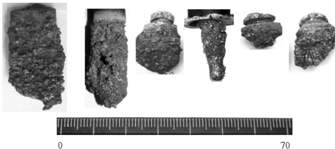
Рис. 2. Внешний вид образцов ферросилиция после выдержки в расплаве чугуна
