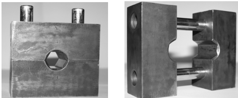
Рис. 4. Общий вид пресс-матрицы для опрессовки оканцевателей на полимерных линейных изоляторах ЛК70–35
