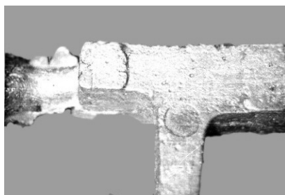
Рис. 3. Внешний вид колосника с прибылью, отлитого в кокиль
