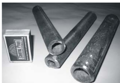
Рис. 2. Наконечники газовых горелок (длина 220 мм, диаметр 26 и 35 мм, толщина стенок 5 мм, масса 0,6 и 0,9 кг) (а) и блок экранных шипов для тепловых электростанций (б). Изготовлены в разовых песчаных формах
