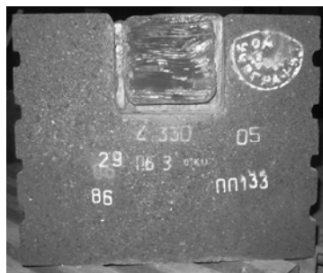
Рис. 2. Залитый чугуном образец подового блока
