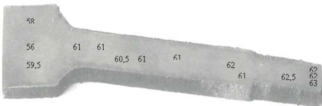
Рис. 4. Значение твердости пуансона по зонам после литья в кокиль и двухкратного отпуска при 500 °С длительностью по 1 ч
