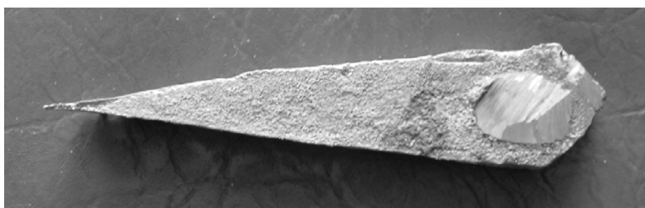
Рис. 3. Форма клиновой пробы после заливки с 1500 °С предварительно перегретого расплава до 1700 °С и выдержки в течение 10 мин
