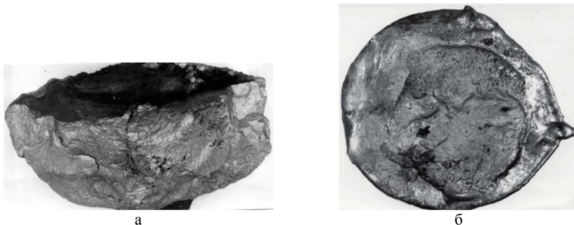
Рис. 1. Внешний вид полученных образцов ферросплавов: а – гарнисаж ферротитана; б – гарнисаж феррониобия
