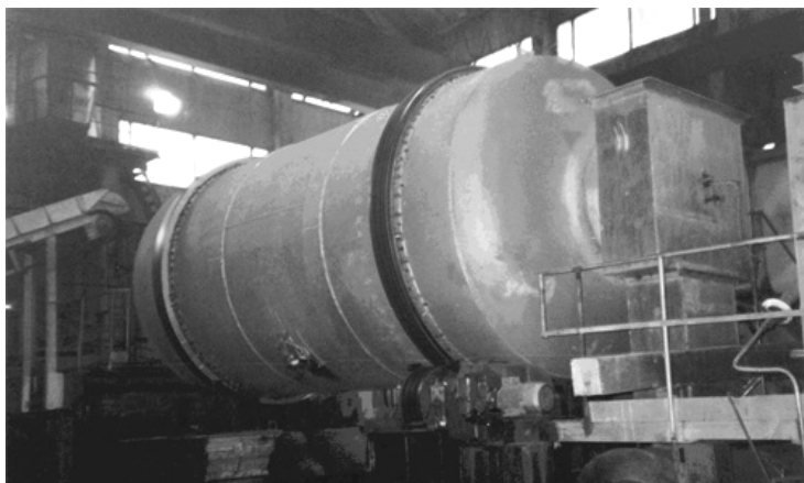
Рис. 2. Роторная печь вместимостью 16 т по алюминию
