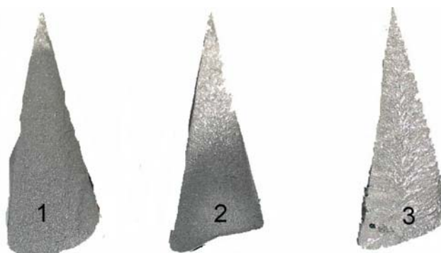
Рис. 1. Типичная макроструктура клиньев опытных чугунов, отлитых в пробу на отбел: 1 – излом серого чугуна с допустимым отбелом (глубина отбела не более 10 мм); 2 – структура половинчатого чугуна (чугун нуждается в графитизирующем модифицировании); 3 – излом полностью отбеленного чугуна (необходимо корректировать состав чугуна по углероду и кремнию или проводить модифицирование)
