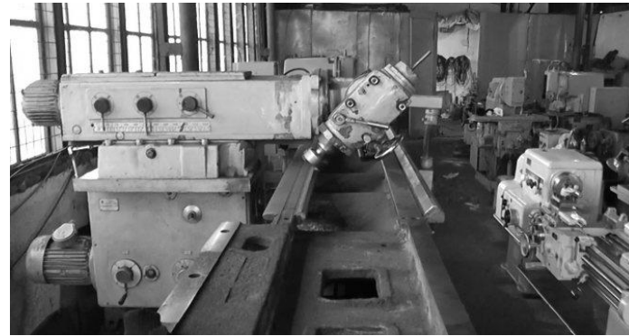
а – периферією кругів; б – торцями шліфувальних кругів Рисунок 2.6 – Шліфування напрямних станин
