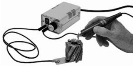
Рисунок 1.1 – Електричний спосіб таврування та маркування
