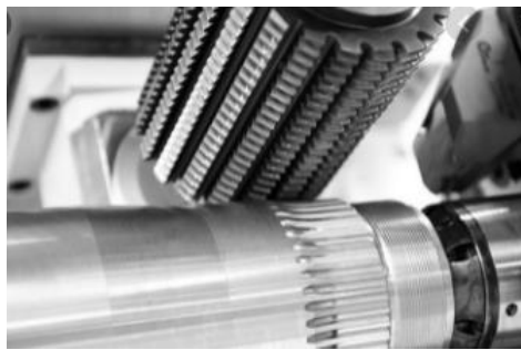
Рисунок 3.8 – Нарізання шліців черв'ячною фрезою
