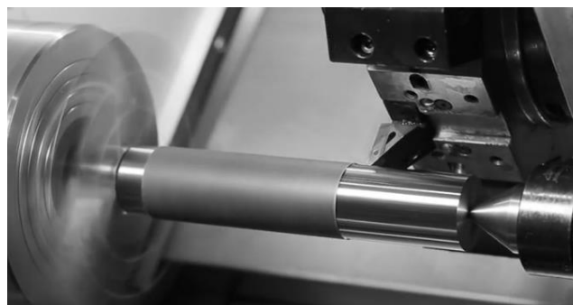
Рисунок 3.3 – Обробка на токарному верстаті з ЧПК
