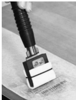
Рисунок 1.2 – Хімічний спосіб таврування та маркування
