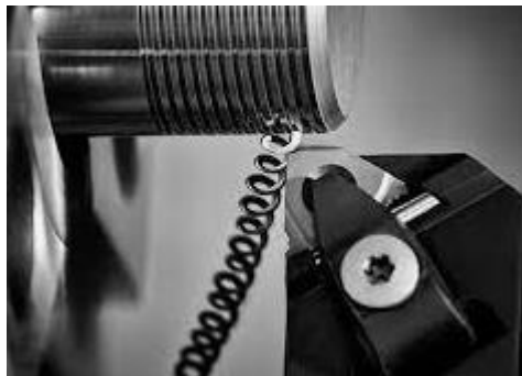
Рисунок 3.17 – Нарізання різі різьбовим різцем
