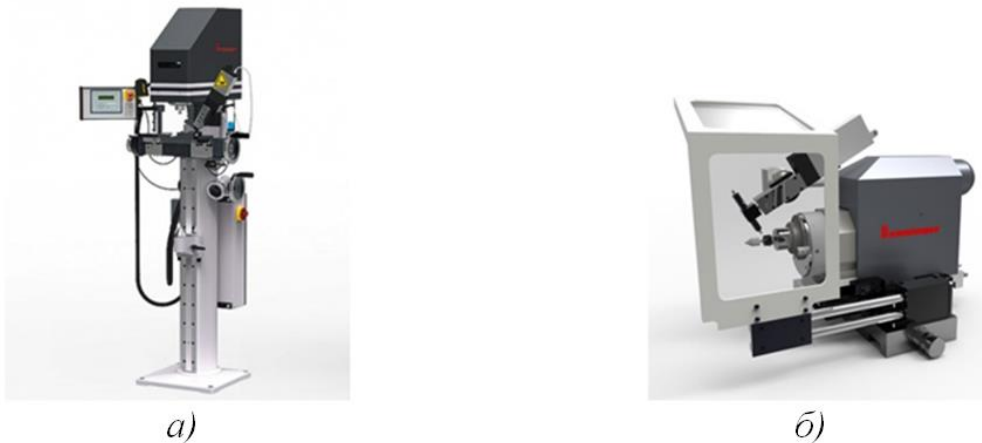
а – вертикальний центрошліфувальний верстат мод. Henninger ZS 102/201/1000; б – горизонтальний центрошліфувальний вузол мод. Henninger ZS25 для встановлення на токарний верстат Рисунок 3.14 – Центрошліфувальні верстати [21]
