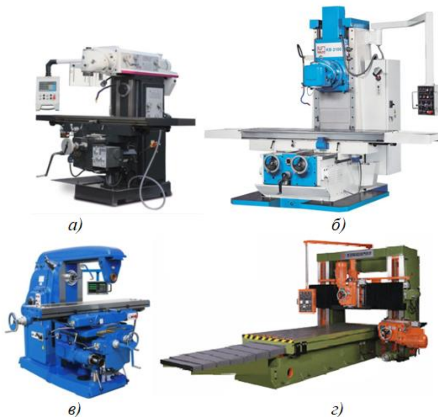
а – вертикальний консольно-фрезерувальний верстат; б – безконсольний фрезерувальний верстат; в – горизонтально-фрезерувальний верстат; г – поздовжньо-фрезерувальний верстат Рисунок 6.1 – Приклади фрезерувальних верстатів[28]
