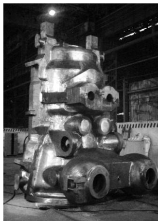
Рис. 1. Отливка «верхняя часть корпуса паровой турбины».
