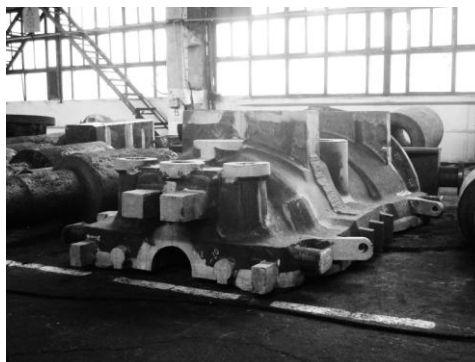
Рис. 2. Отливка «нижняя часть корпуса паровой турбины».
