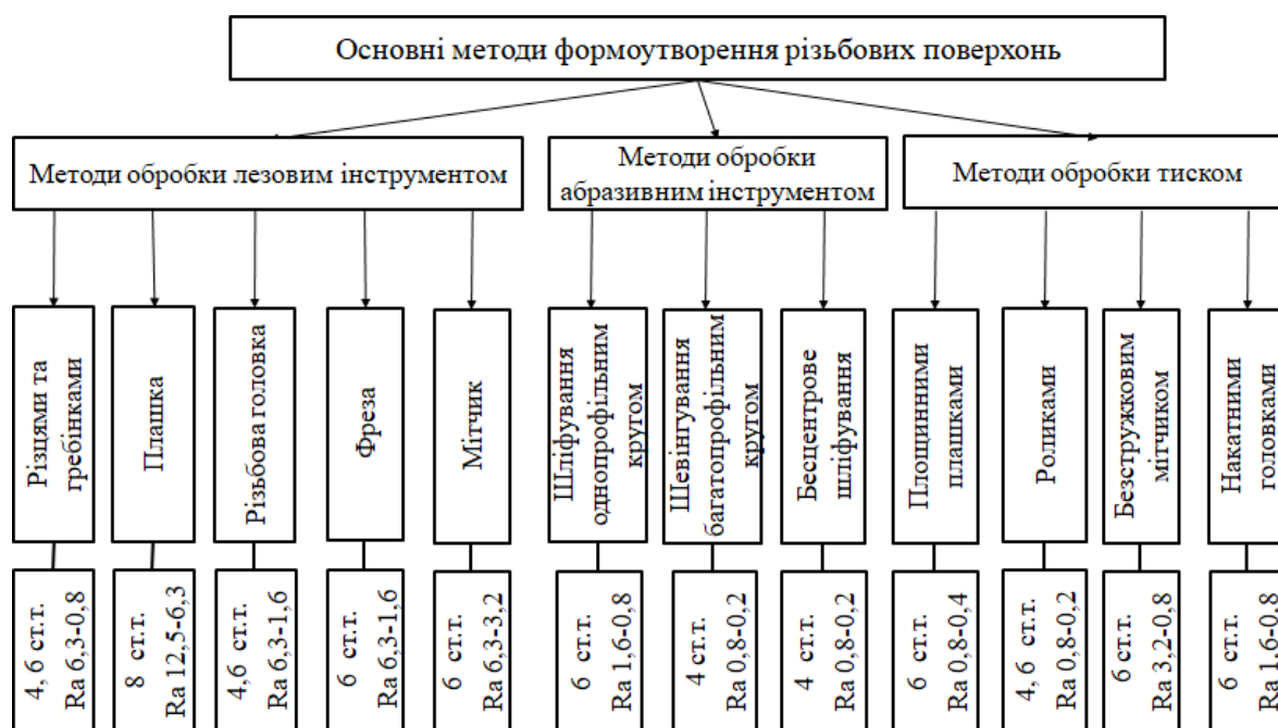
Рисунок 7.1 – Класифікація методів формоутворення різьбових поверхонь
