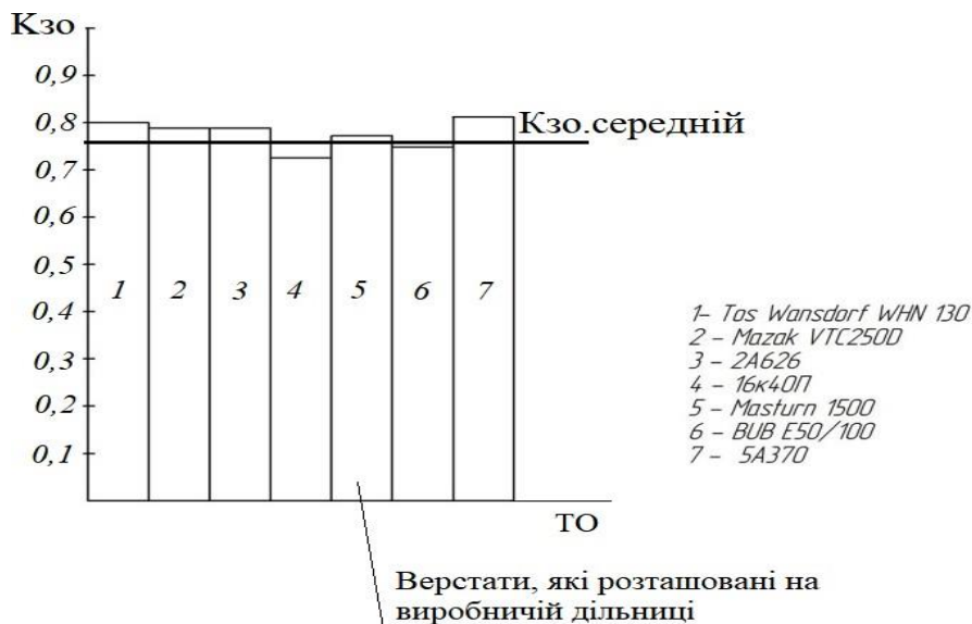
Рисунок 2.1 – Графік завантаження обладнання
