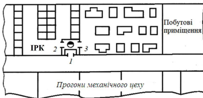
Рисунок 1.39 – Компоновання відділення з відновлення інструментів та ІРК [7]
