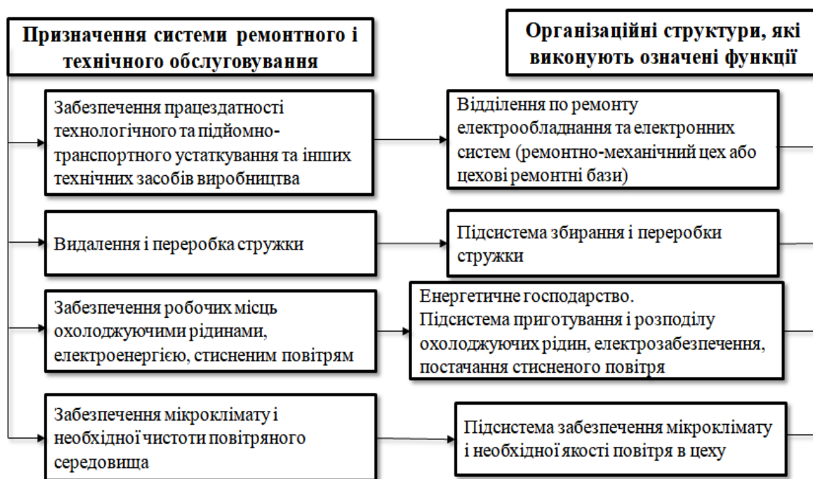
Рисунок 1.40 – Призначення системи ремонтного й технічного обслуговування та організаційні структури, які забезпечують її роботу
