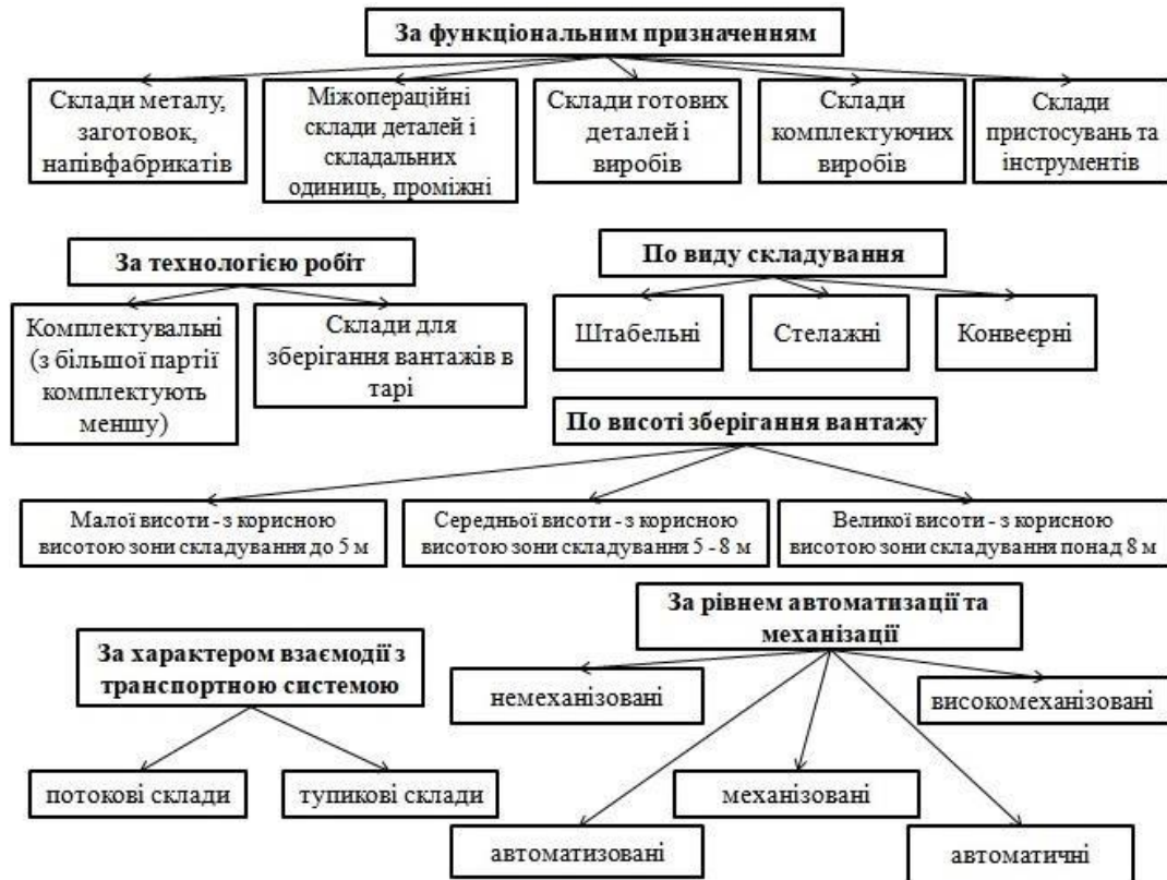
Рисунок 1.21 – Класифікація складів у машинобудівному виробництві: 1 – за функціональним призначенням; 2 – за технологією робіт; 3 – за видом складування; 4 – за висотою зберігання; 5 – за характером взаємодії з транспортною системою; 6 – за рівнем автоматизації та механізації
