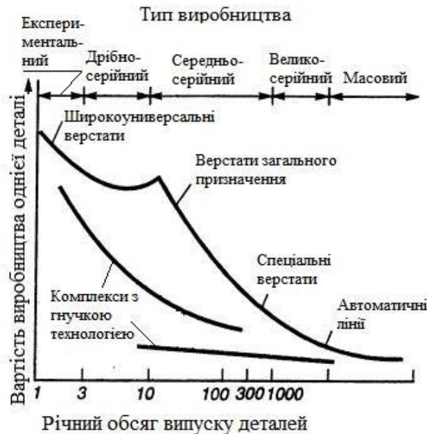
Рисунок 1.9 – Визначення номенклатури технологічного обладнання [18]
