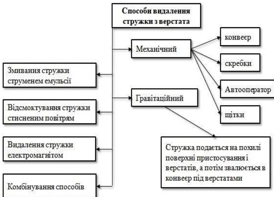
Рисунок 1.44 – Способи видалення стружки з верстатів
