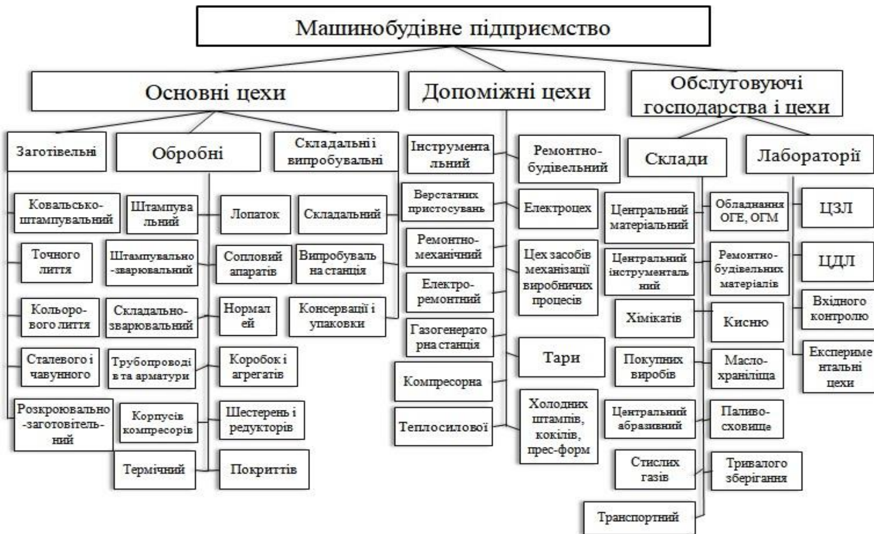
Рисунок 1.2 – Приклад структури машинобудівного підприємства
