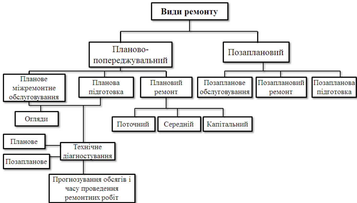
Рисунок 1.42 – Класифікація видів ремонту обладнання
