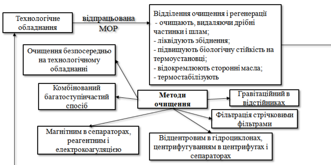
Рисунок 1.55 – Схема циркуляції МОР та методи її очищення
