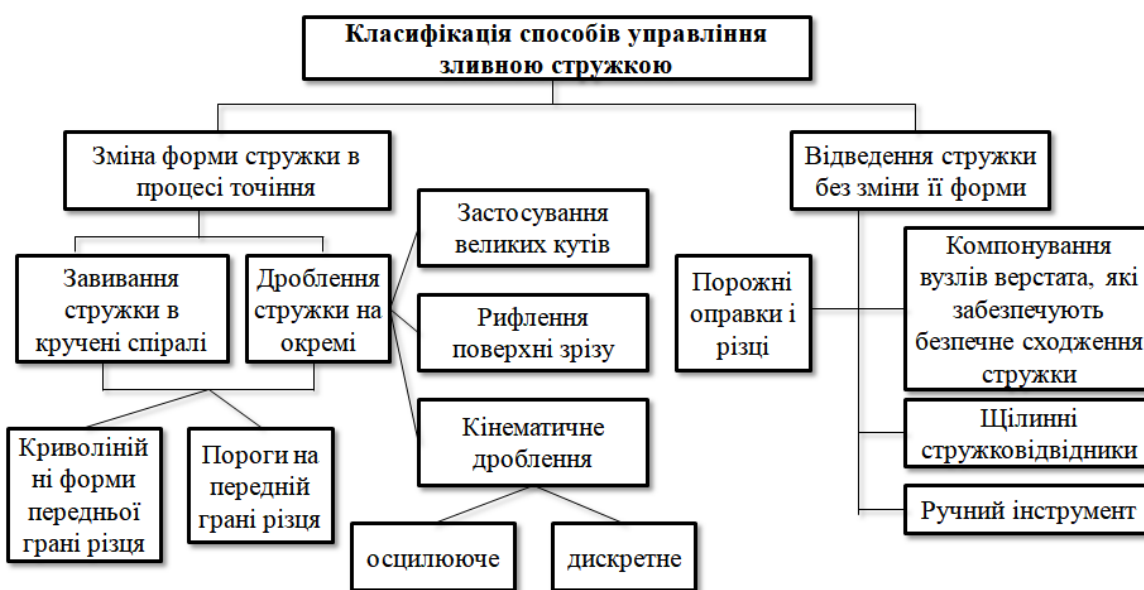
Рисунок 1.45 – Способи керування зливною стружкою
