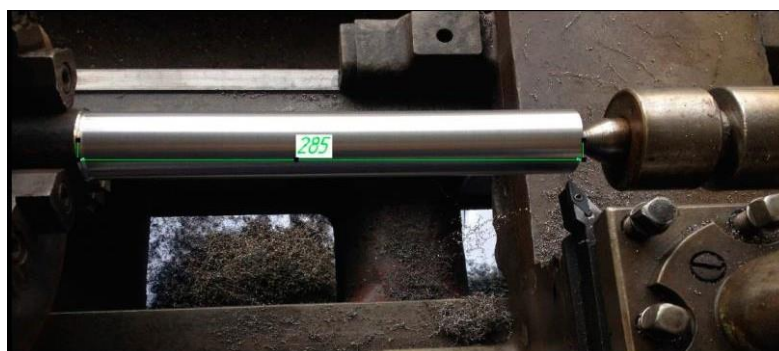
Рисунок 6.18 – Підготовка заготовки шляхом попереднього обточування
