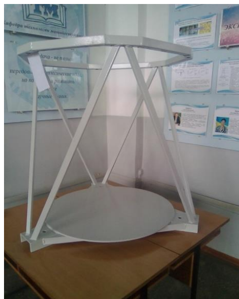
Рисунок 5.1 – Рама МПС типу «дельта»
