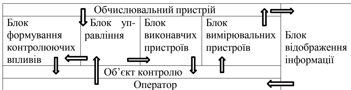
Рисунок 5.26 – Узагальнена функціональна схема АСУ
