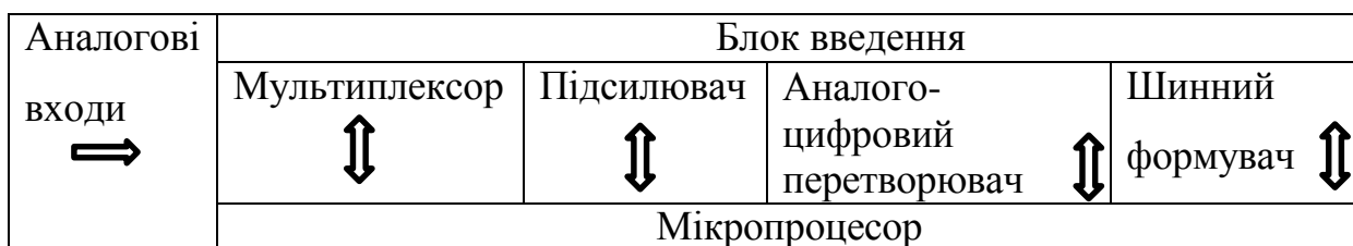
Рисунок 5.23 – Структурна схема контролера на основі мікрокомп'ютера
