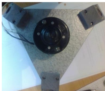
Рисунок 5.9 – Платформа дельта-машини в зборі
