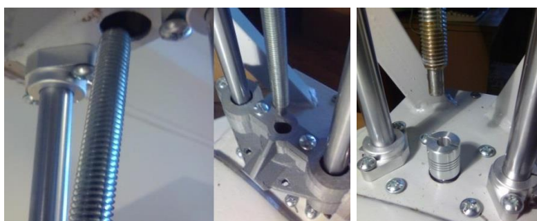
Рисунок 5.12 – Монтаж ходового гвинта
