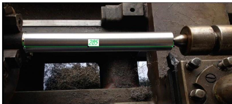
Рисунок 6.18 – Підготовка заготовки шляхом попереднього обточування
