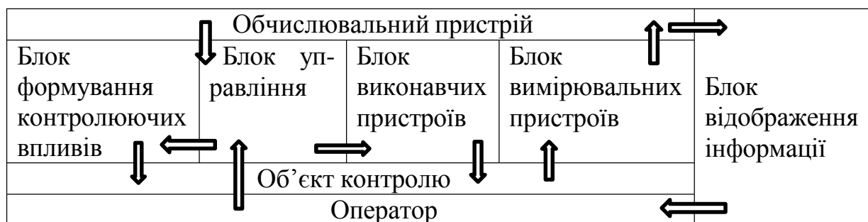
Рисунок 5.26 – Узагальнена функціональна схема АСУ
