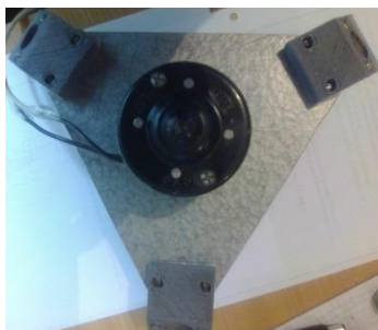
Рисунок 5.9 – Платформа дельта-машини в зборі
