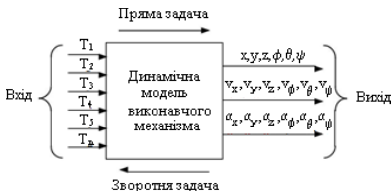
Рисунок 4.4 – Взаємозв’язок вхідних і вихідних параметрів моделі, де T_1, T_2 \dots T_n – керовані ланки МПС
