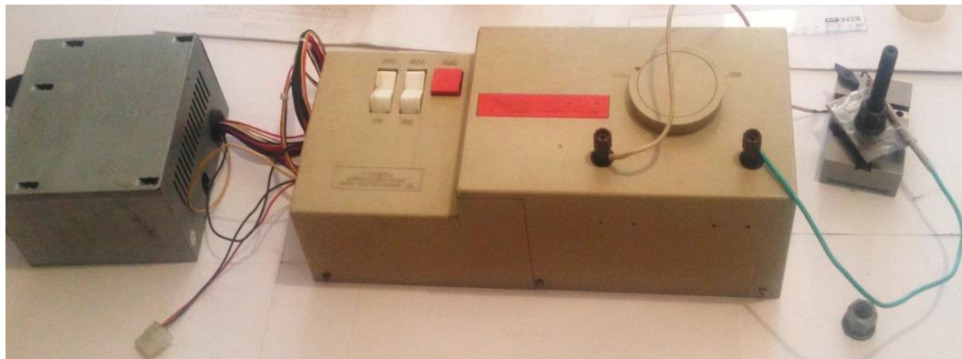
Рисунок 6.17 – Експериментальний стенд генерування високовольтних розрядів
