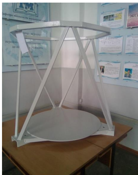
Рисунок 5.1 – Рама МПС типу «дельта»
