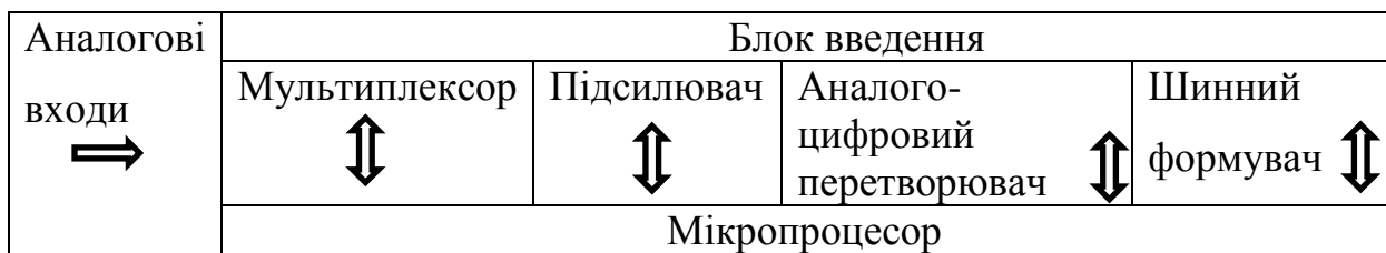
Рисунок 5.23 – Структурна схема контролера на основі мікрокомп'ютера
