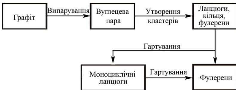
Рис. 4.11. Схема отримання фулеренів із графіту [19]
