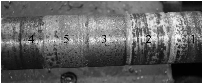
1 – Al_2O_3 + Fe_2O_3 ; 2 – Al_2O_3 + KMnO_4 ; 3 – KMnO_4 + Fe_2O_3 ; 4 – KMnO_4 + CЧ10 ; 5 – KMnO_4 + Fe_2O_3 + Al_2O_3 Рисунок 3.51 – Зразок після оброблення
