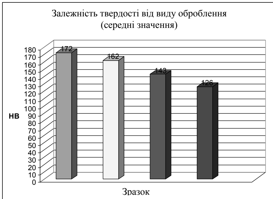
Рисунок 3.62 – Залежність твердості зразків від наявності шару міді з наступною обробкою вигладжуванням
