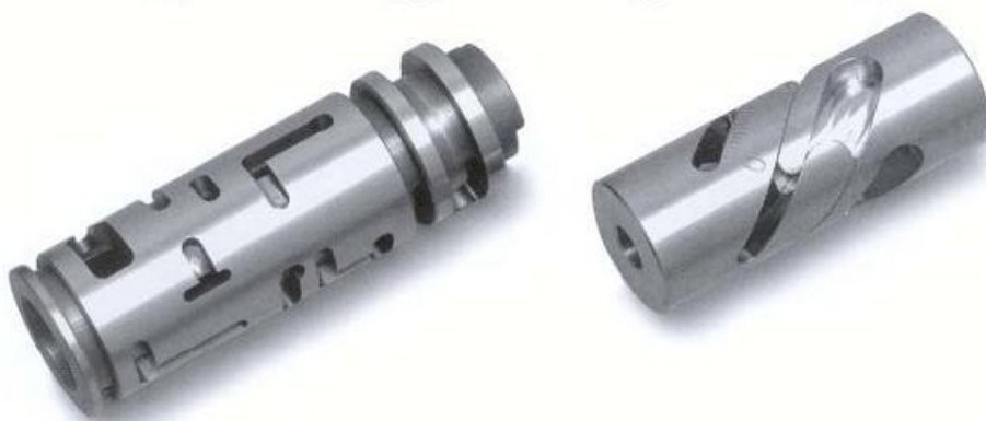
Рисунок 6.1 – Деякі види обробки, які виконуються на токарських ОЦ
