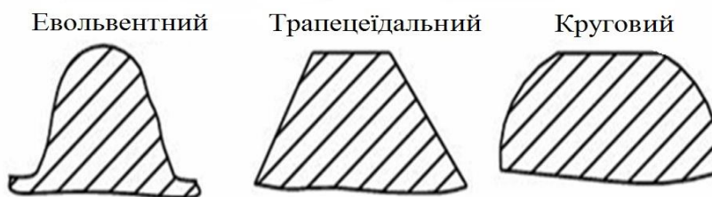
Рисунок 12.5 – Профілі зуба зубчастих передач
