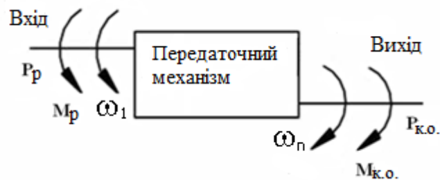
Рисунок 7.4 – Схема навантаження механізму
