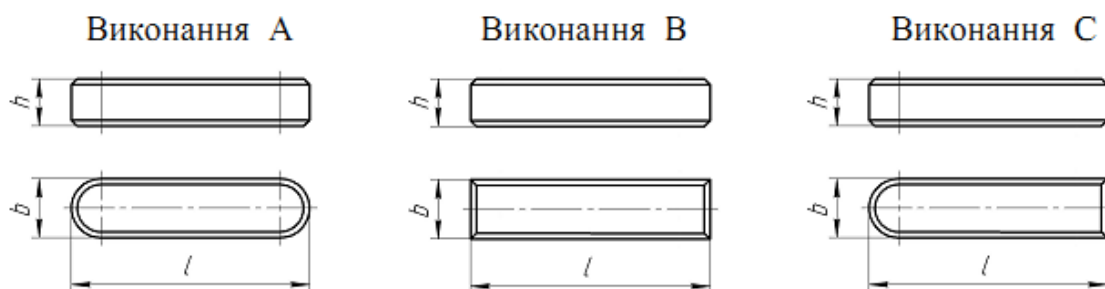
Рисунок 19.2 – Варіанти конструктивного виконання призматичних шпонок
