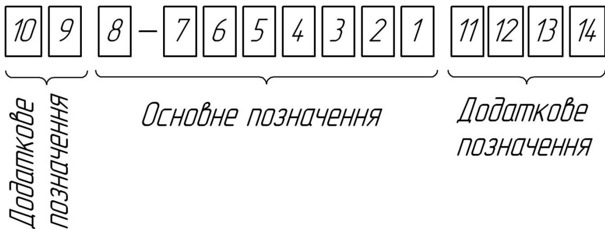
Рисунок 15.6 – Основні та додаткові позначення підшипників кочення
