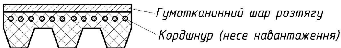
Рисунок 10.7 – Переріз поліклинового пасу
