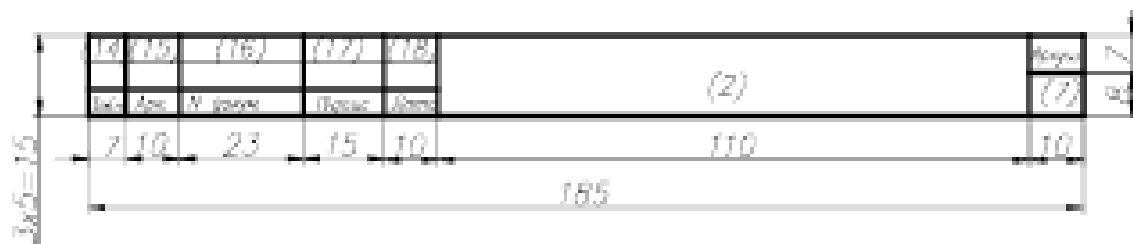
Рисунок 1.6 – Основний напис для текстових конструкторських документів (наступні сторінки).
